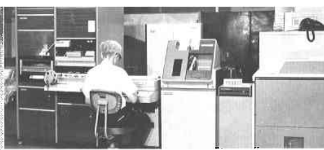
↑ 大型計算機センタと結びリモートバッチステーション このステーションはミニコンFACOMU 200システムで構成され、2400ボー同期式通信回線で本郷の大型センタと結ばれ、リモートバッチ処理を可能としている —渡辺・浜田研究室—
