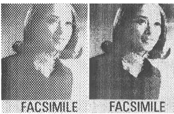
↑ 2値表示装置によるハーフトーン表示 4×4の濃度パターンによる中間調表示。写真左は擬似網点。右は最適配列ドットパターンを用い、ファクシミリに記録したもの —安田研究室—
