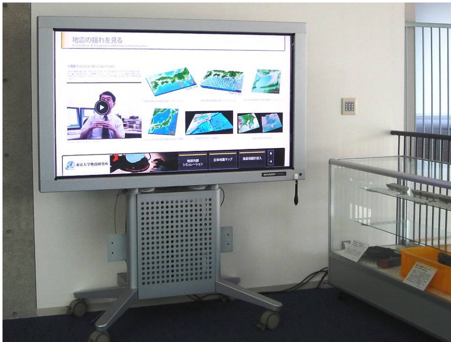
図1 地震研究所1号館2階ラウンジに設置された対話型リッチコンテンツ表示システム (65インチ型). 幅は157cm.
