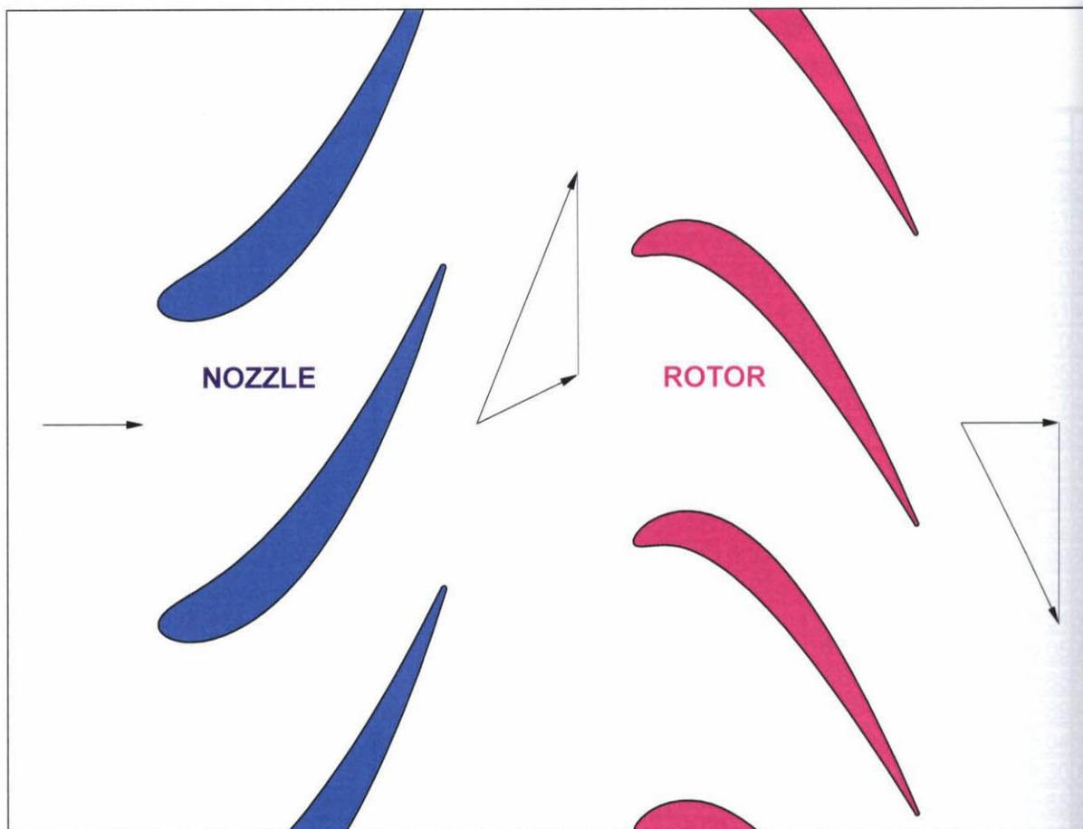
付図 1.11 タービン静翼・動翼の配置（原寸）と設計点における速度三角形
