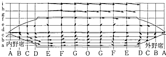
図7 断面1における風速 (\sqrt{u_r^2 + w_r^2}/U_\infty) の分布 (屋根あり) \sqrt{u_r^2 + w_r^2}/U_\infty = 1 の長さを \rightarrow とする。 U_\infty = 6 \text{ m/s}
