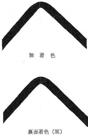
図10 着色による板厚減少緩和効果 (紫色材料, 厚さ2mm, 幅10mm, 外側照射)
