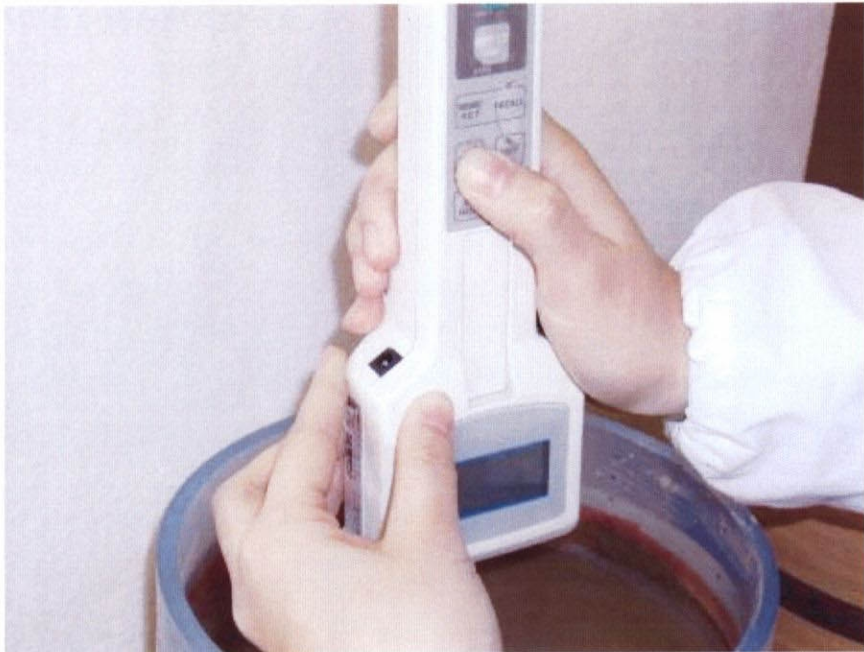
Photo 6-4 表面土壌硬度の測定法
