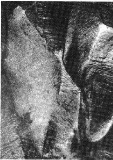
図24 Al多結晶試験片の引張試験後の表面 (温度 100 °C, ひずみ速度 0.031/min, ×60)
