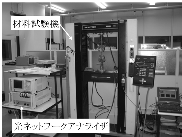
図 4.2 複素スペクトルを測定するための試験装置
