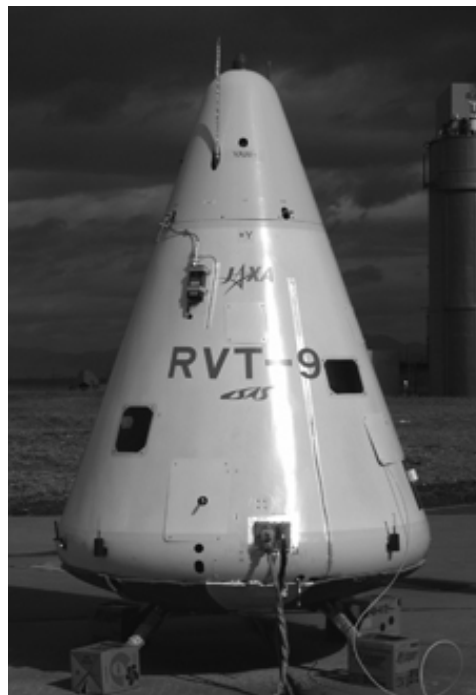
図 5.1 再使用ロケット実験機
