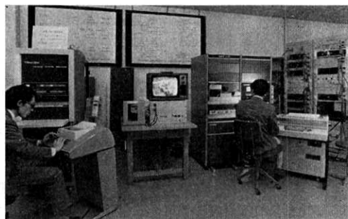
写真1 交通流解析システム、右端は交通流シミュレータ TRN*SIM I、左端は TRN*SIM II (中央は交通情報の収集、解析などを行なう別のシステム) で、いずれも本所中央設置の計算機と接続されている。
