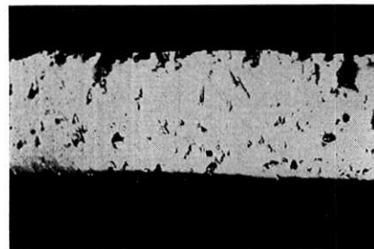
写真 2 圧縮成形時に生じた鉄ウィスカ表面のきず 4)
