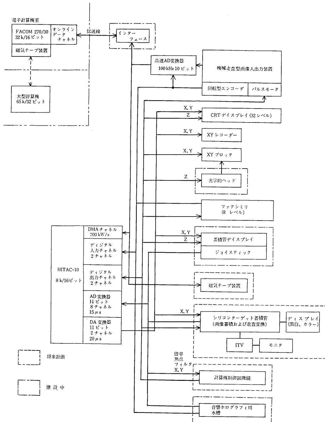
図1 画像処理研究施設の構成
