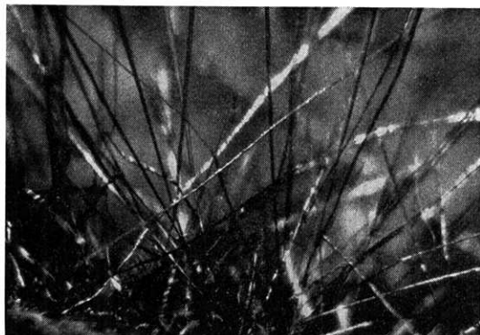
写真2 ボート壁面に種々の方向で生長した鉄ウイスキー (生成条件は 677°C, 水素 300 cc/min) ×20
