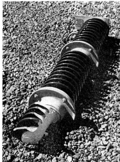
写真5 母線ベドスタル碍子の縦裂. 手前が固定側 (Pacific Intertie Converter Stn. 交流側)
