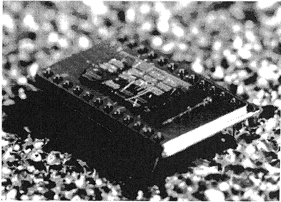
図6-18 メタルパッケージのベースに取付けられたLTU
