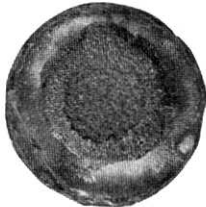
写真 1 CO 2 混合ガス中 1200°C にて 60 分還元焼成した B 200 80 C 200 20 の断面写真
