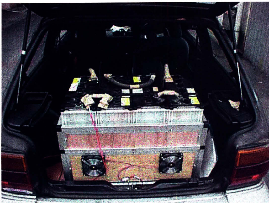
図 B.1: 作成した電池ケース. このケースには電池が 2 段積みされ, 計 8 個収納されている. 下層の 4 個は外部からは見えない. ファンが見えるが, この下層の電池の冷却と, また主に過充電時の水素放出を目的としたもの. このケースの外部にさらに 4 個の電池を設置し, 計 12 個となる.
