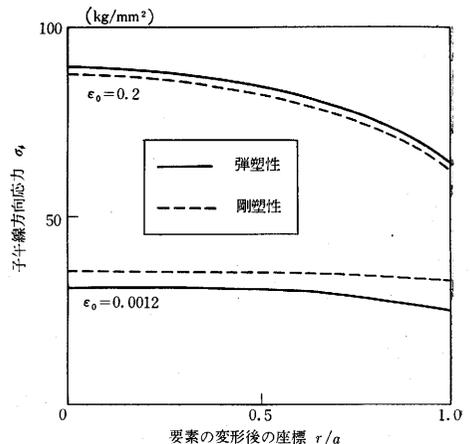
図 5 子午線方向応力  $\sigma_\phi$  の分布
