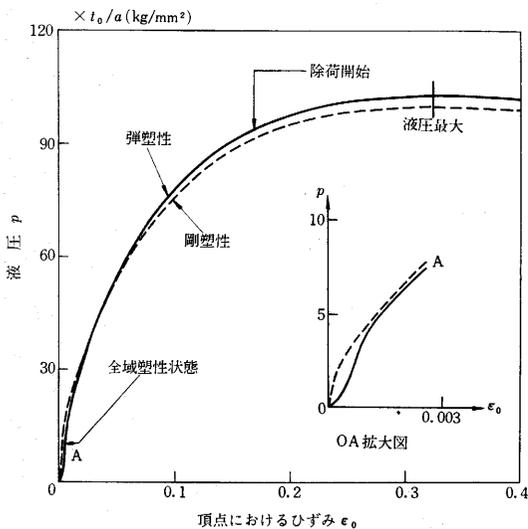
図 2 頂点におけるひずみと液圧の関係
