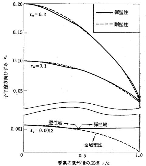
図 3 子午線方向ひずみ  $\epsilon_\phi$  の分布
