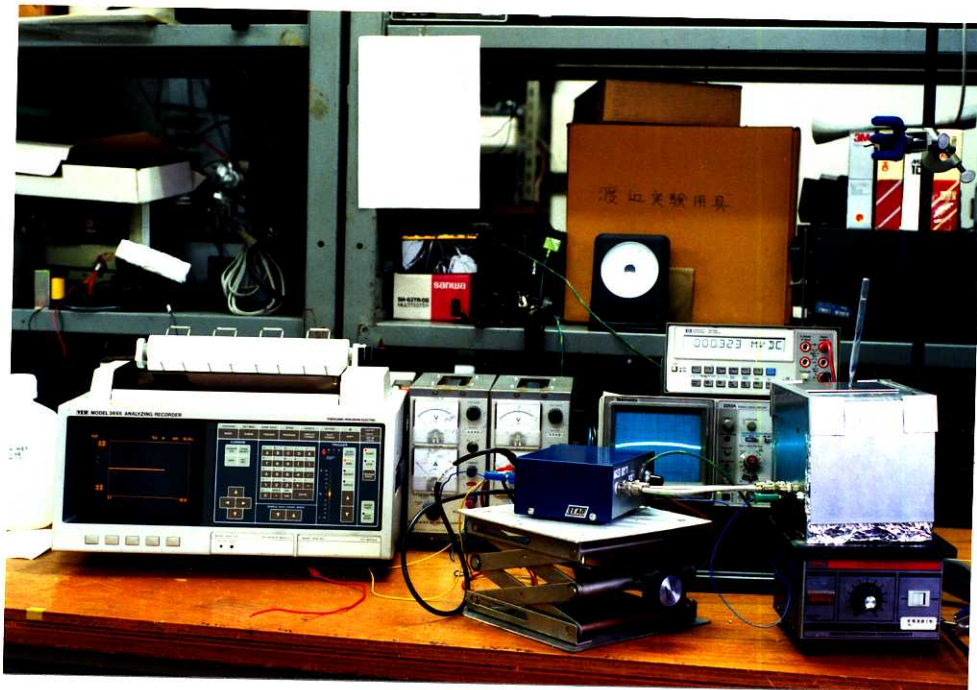
図6-9 表面電位測定系全体
