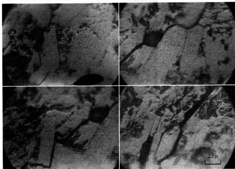
写真6 イタピライト鉱石の粒界に走るきれつ
