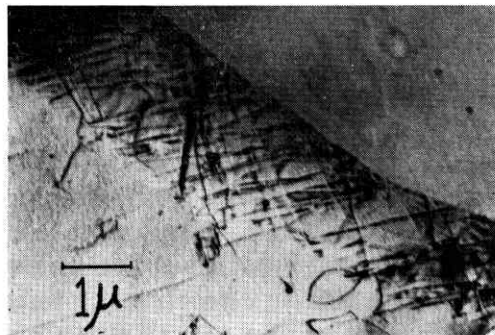
写真3 粒界微細構造の一例。通常の粒界転位像よりは細かく、規則的な線列がみえる。
