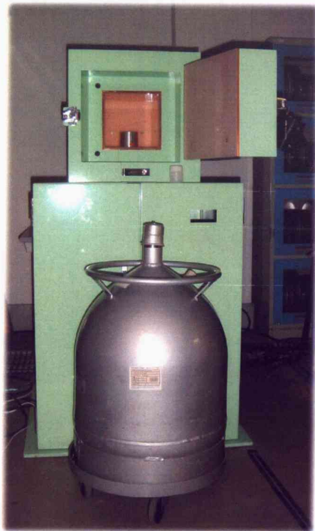
図 3 - 1 5 放射線強度測定器 (米国 ORTEC 社製 GMX29PHP-Ge 検出器)
