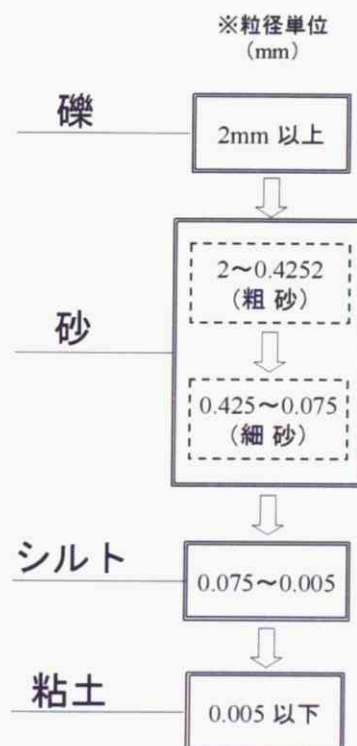
図 3-8 解析式粒度分布測定装置 SALD-3000S 及び粒径による分類 (JIS A1204)
