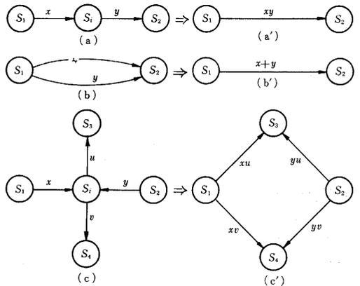
図 2 状態図の基本的変換
