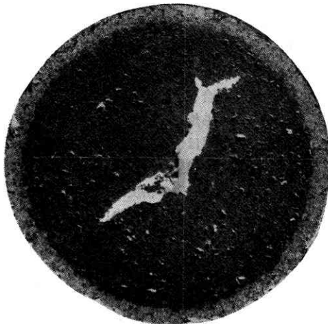
写真 4 造粒型膨張頁岩粒の断面
