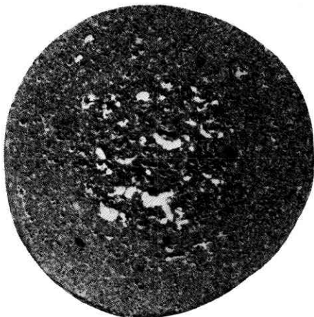
写真 5 焼成フライアッシュ粒の断面
