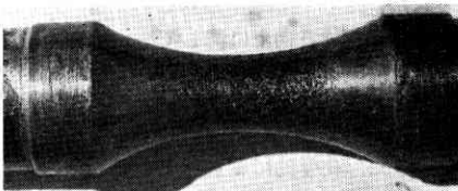
図 96 腐食疲れ試験後の高周波焼入れ試験片表面の粗面化状態 (RT44-1)
