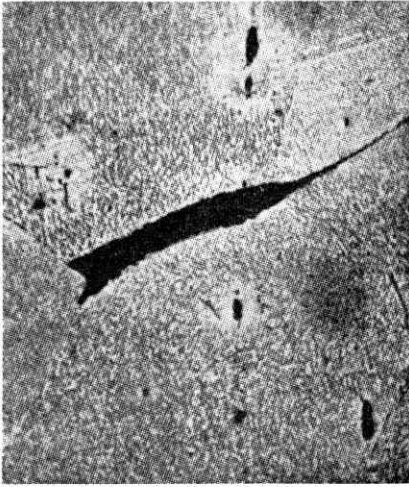
Nimonic 90 合金. クリープ応力 12.5 kg/mm 2 500 倍 (McLean による. 1962.)
