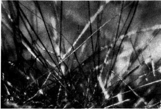
(a)  $Al_2O_3$  ポート内壁に成長した鉄のせんい状結晶 20×
