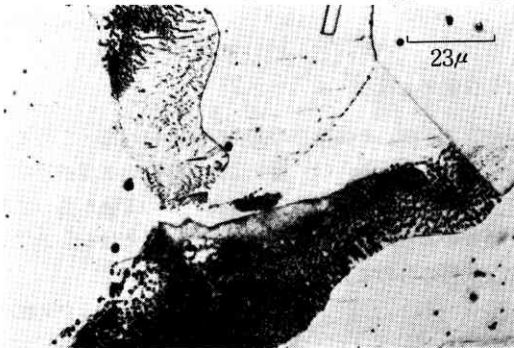
写真・1 Co 2.85% 合金, 600°C x 15 hr 時効後の粒界反応 ×520
