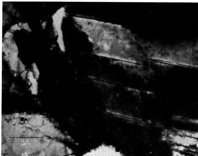
写真・6 ワット法ニッケルメッキ層： 400^{\circ}\text{C}\times 2\text{ hr}
