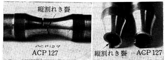
第 5 図 縦われき裂の入った試験片 (軟鋼)
