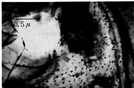
写真5 Cu-Cr (0.49%) 合金, 同一溶体化処理後, 500°C×30 分時効した後の組織
