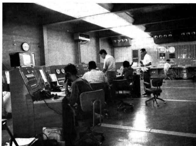
↓ コントロール・センタ内部 発射管制司令卓（手前）と発射管制盤
