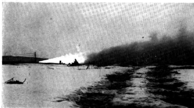
⇓ ミュー 1400 1/3 エンジン 地上燃焼試験 (昭和 39 年 3 月 5 日)
