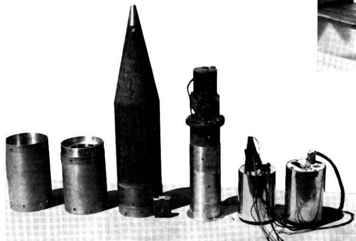
← カッパ 8L型 3号機に搭載のプロトン 磁力計およびテレメータ送信機
