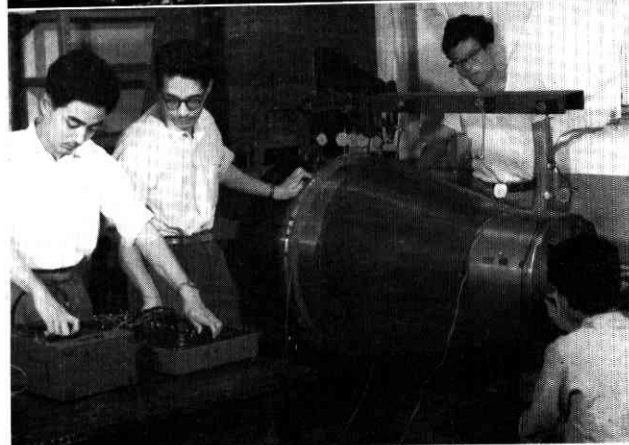
↑ ラムダ・ロケット接手部の強度試験
