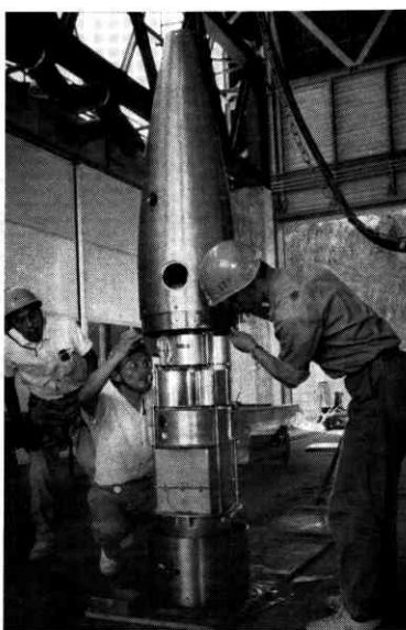
↓ ラムダ3型1号機 頭部の組み立て (昭和39年7月)
