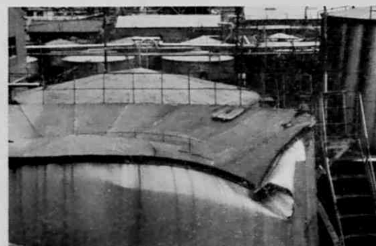
第 4・7 図 液面共振によるタンク鏡板の破壊
