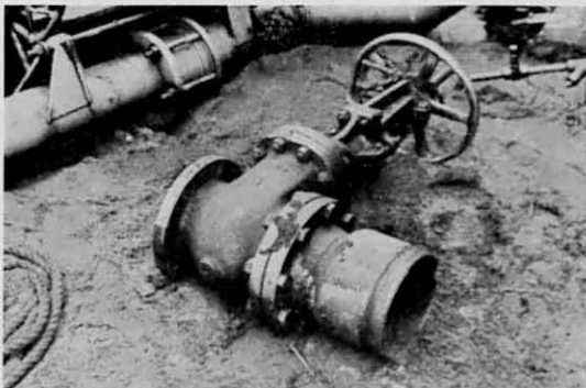
第4・14図 管用ねじの引抜きによる損傷例、石油タンク・ノズルに直結していた
