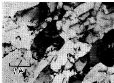
写真 1 99.99% Al 約 80% 圧延後 200°C 1 時間加熱
