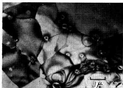
写真 4 Al-Zr (0.29%) 合金約 80% 圧延後 350°C 1 時間加熱
