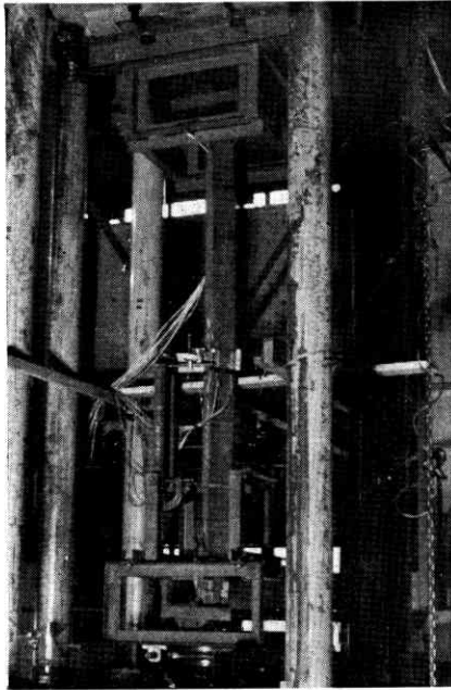
第 44 図 柱の偏心圧縮試験装置
