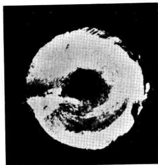
写真2 水素脆化を受けない試料の破断面 0.3mmφピアノ線 表面カドミウムメッキ 捻回数 200 以上
