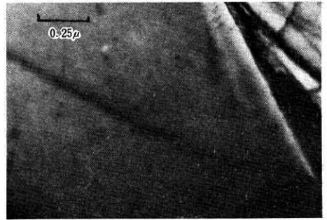
写真 1 Cu-Cr(0.30%)合金 950°C×1.5 時間加熱後、水焼入れしたままの組織 ×40,000
