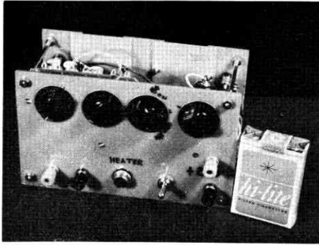
写真 1 制御装置 (表側)
