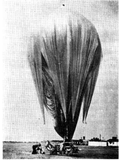
英国ブリストル大学の Powell 教授等の気球ランチャである。気球に別のシートをかぶせて使い、独特のものである。放球後このシートは落ちる。
