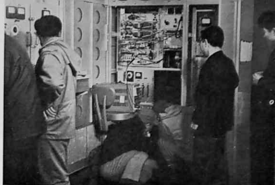
→ 新型自動追尾 レーダ装置 送・受信部 送信出力 500 kW 受信にはパラメトリック増幅器が使われている。
