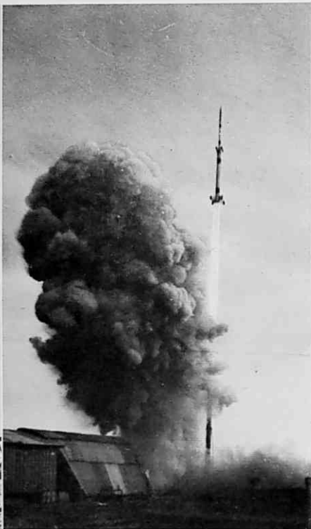
↑ K-9M-1号機(37年11月) 8型の性能向上機で、最高高度350kmの 性能をもつ。
