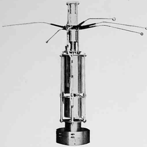
← 電離層直接観測器 開頭により5本のプローブが傘型に開く。上端には地磁気姿勢計検出器がのっている。 (K-8-10).
