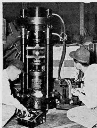
第8図 推力計校正装置
