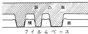
第6図 フィルムに凸版が打ち込まれた瞬間の断面図
