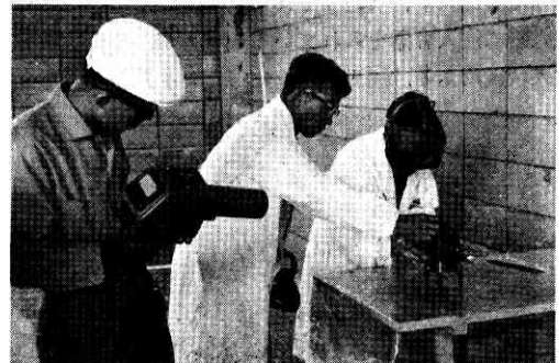
写真 2 アルミニウム罐を Pb 厚さ 40mm の切断器に入れて、その上部を切り取っているところ
