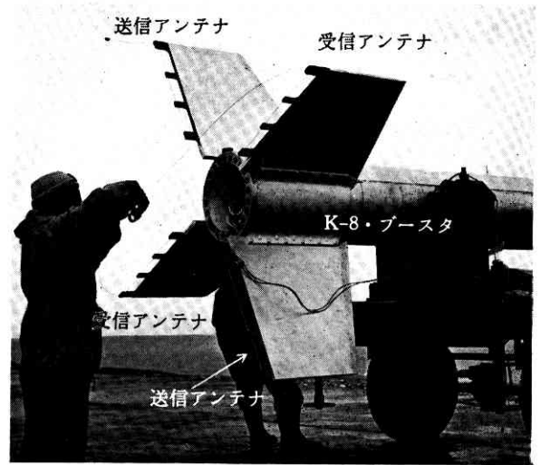
↑ カッパ 8 型ブースタ搭載のドバップ送受信用尾翼アンテナ
