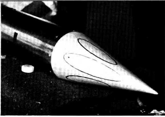
↑ 風・気温観測のための発音弾射出部 6H用で6発をノーズコーンに組み込み順次に前方に発射する。図は射出前の外観。
