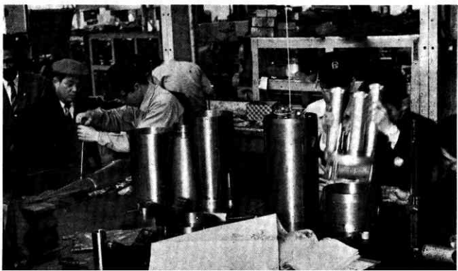
↓ 大気光・電離層測定器と機体との組み合せ点検
