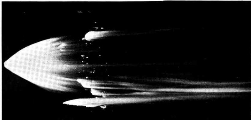
← 電気雷管によるメタン着火 (第 31 図)
