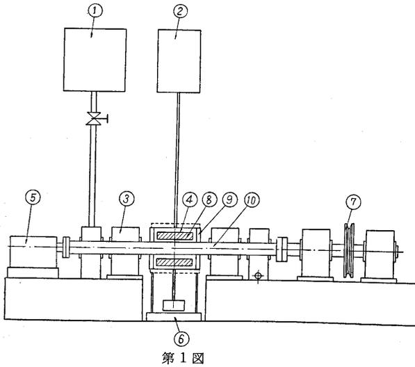
ニクロム線の消費電力で決定し、流体から軸表面に伝わった熱量  $Q_2$  は管内の絶縁油の温度上昇より近似的に求める。摩擦発熱量  $Q_r$  は潤滑油の持ち去る熱量  $Q_3$  と上の  $Q_1$  および  $Q_2$  とのバランスより  $Q_r = Q_2 + Q_3 - Q_1$  として求める。一方  $Q_r$  は偏心量がない場合の計算値でチェックしたが、実験値との間に大きい差はなかった。
