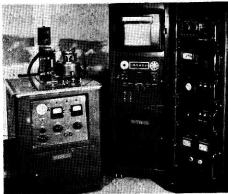
(c) X線 diffractometer 左よりX線発生装置および Goniometer, 計数記録装置, X線回折用試料加熱自動制御装置
