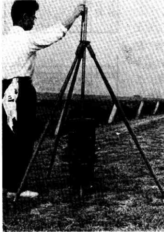
第 2 図 直径 5 cm の円柱に載荷する静荷試験
