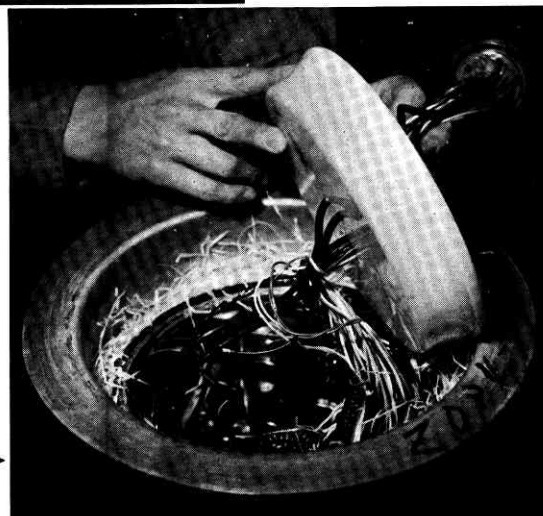
サーミスタ用の電源 と切換装置 圧力容器の中のジャ ーに収め、圧力と温 度の影響を防ぐ →
