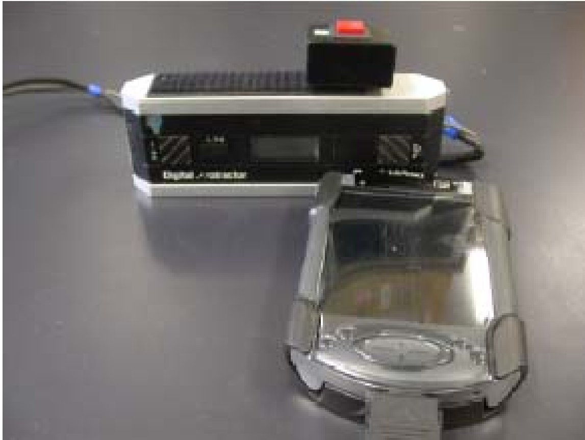
Fig. 2・2・1 SHEF 落葉広葉樹林での葉傾角測定に用いた角度計とPDAを用いたロガーシステム
