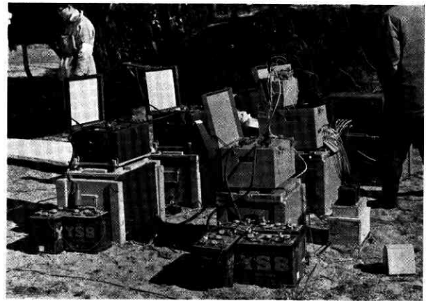
↓ TW受音班の受音装置および記録機
